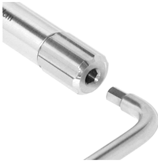
Fig. 8 Il montaggio della chiave risulta completato quando il complessivo molla/arresto (6) è introdotto nella leva di comando (4) e la vite di regolazione (7) è avvitata in quest'ultimo. Al termine del montaggio, procedere a una verifica funzionale azionando la bussola: lo strumento funziona perfettamente quando dalla chiave si ode un clicchetto regolare. Prima dell'uso, è tassativo verificare il montaggio e il funzionamento della chiave a cricchetto.
