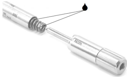
Fig. 8 Il montaggio della chiave risulta completato quando il complessivo molla/arresto (6) è introdotto nella leva di comando (4) e la vite di regolazione (7) è avvitata in quest'ultimo. Al termine del montaggio, procedere a una verifica funzionale azionando la bussola: lo strumento funziona perfettamente quando dalla chiave si ode un clicchetto regolare. Prima dell'uso, è tassativo verificare il montaggio e il funzionamento della chiave a cricchetto.
