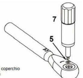
Fig. 8 Avvitare il coperchio sulla testa
