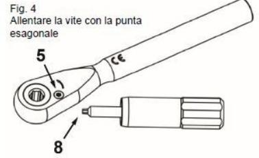
Fig. 4 Allentare la vite con la punta esagonale
