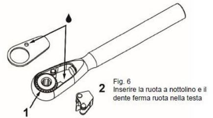
Fig. 6 Inserire la ruota a nottolino e il dente ferma ruota nella testa
