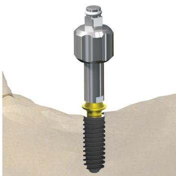
Avvitare la Base FAST 0° con l'Avvitatore esagonale CH.2,6.
